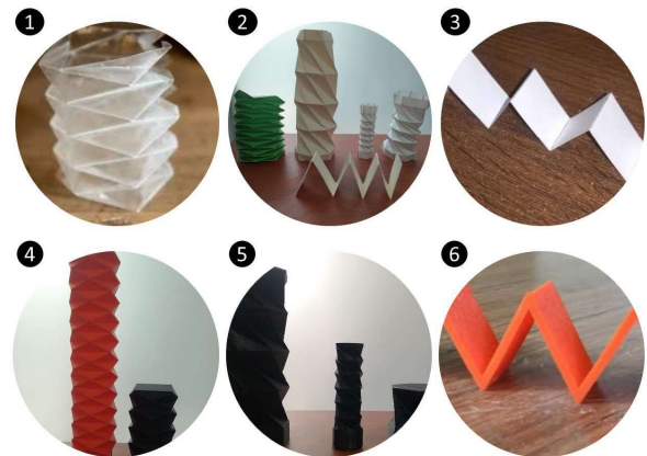
Figura 4. Modelos 3D Yoshimura, Kresling y Zigzag en doblez (1-3) e impresión con TPU (4-6).
